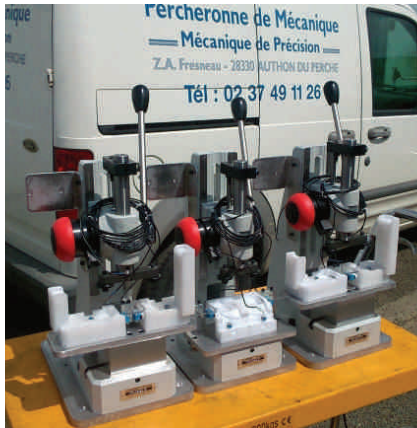
Montages et assemblages mécaniques - 3 presses de clippage
