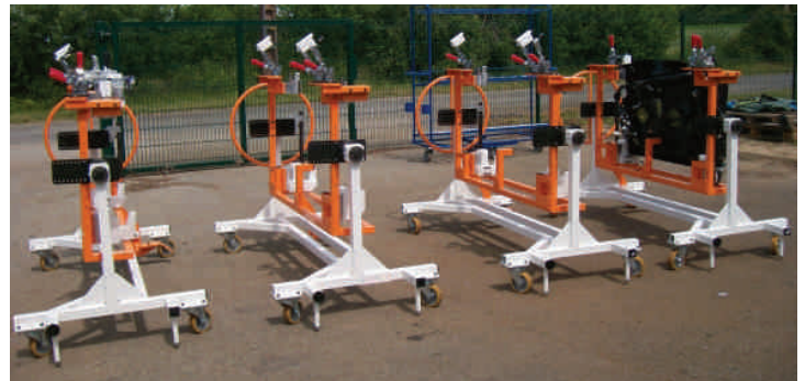
Montages et assemblages mécaniques 4 luges d'assemblages pour blocs de ventilation
